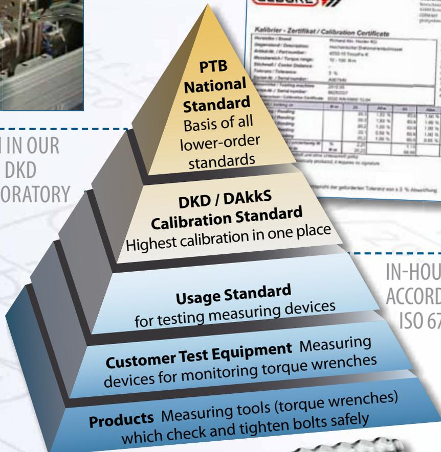
IN-HOUSE CALIBRATION ACCORDING TO DIN EN ISO 6789:2003
